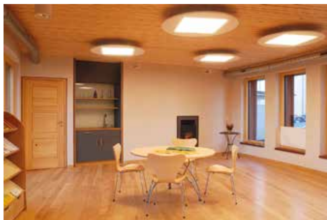
Flimmerfreie diffuse LED-Beleuchtung mit verschiedenen Lichtfarben und Beleuchtungsstärken
