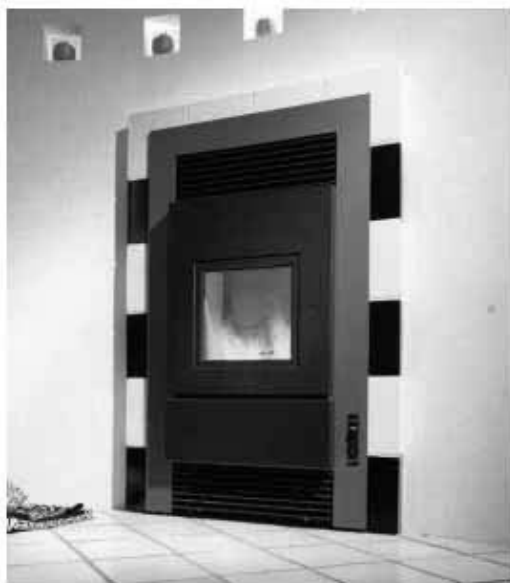
Abb.: Pellet-Kaminofen als Einbau-Zentralheizungskessel mit einer Kesselleistung von 2 - 10 kW (wasserseitig ca. 80 %, luftseitig ca. 20 %), massiv eingemauert. Pellet-Vorratsbehälter 38,5 – 55 kg. Quelle: Wodtke (PE water+), www.wodtke.com
