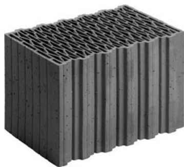
Abb. 12 Planziegel für einschalige Außenwände ohne Kerndämmung – Unipor W09 Rohdichte 0,6 \text{ kg/dm}^3 Wärmeleitzaahl 0,09 W/mK
